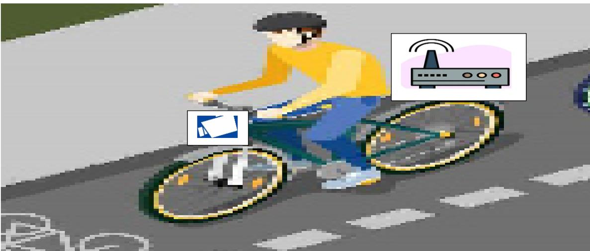
Kamera vorne am Lenker nimmt Daten auf und übermittelt sie an Empfänger auf dem Gepäckträger, der die Daten an die dafür zuständigen Stellen weiterleitet.
